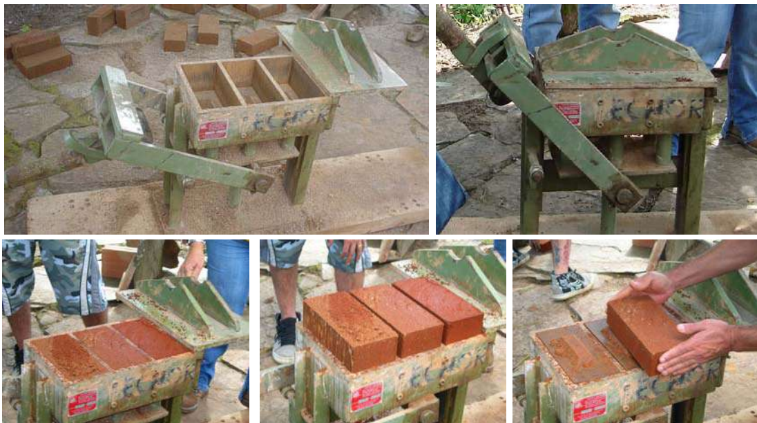
Figura 5 – Moldeado de BTC
