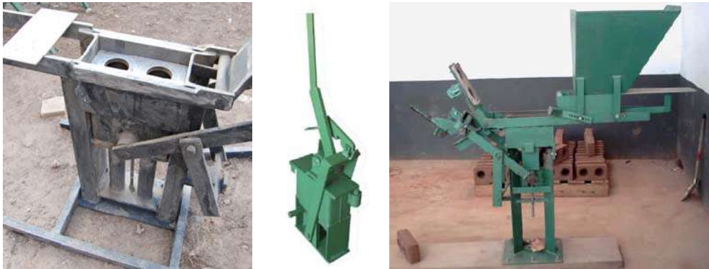
Figura 10 – Prensa Mattone (a la izquierda) y más dos modelos de prensas manuales
