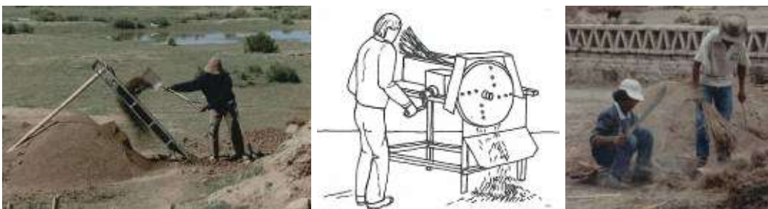
Figura 3 – Tamizado de la tierra; trituración mecánica y corte manual de fibras vegetales
